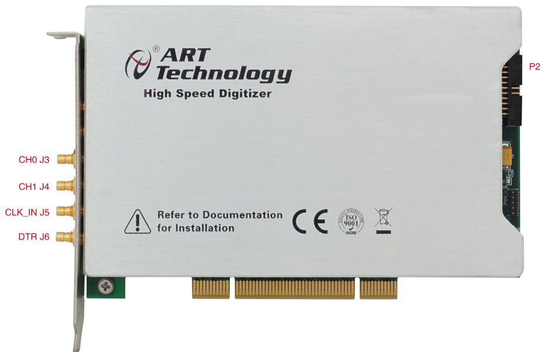
图 3-3-1 PCI-8522B 元件布局图
